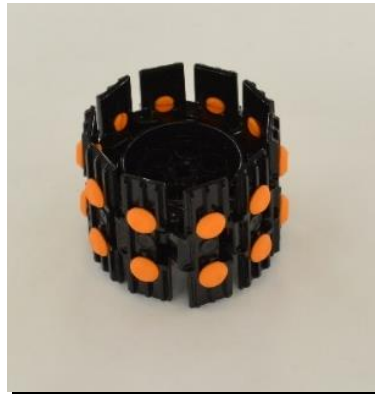
Εικόνα 8 Ρόδες φτιαγμένες από κομμάτια ερπυστριών
