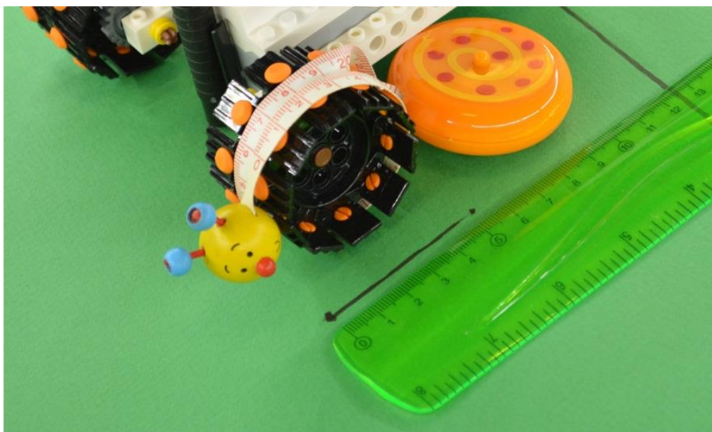
Εικόνα 6 Μέτρηση της περιμέτρου του τροχού καθώς και της απόστασης που διένυσε το όχημα
