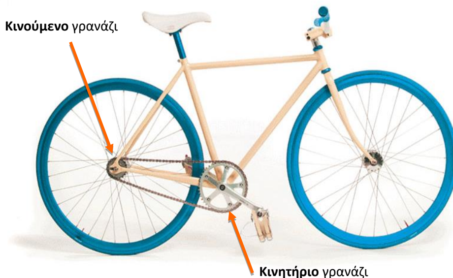
Εικόνα 24 Το ποδήλατο διαθέτει σύστημα γραναζιών για την κίνησή του
