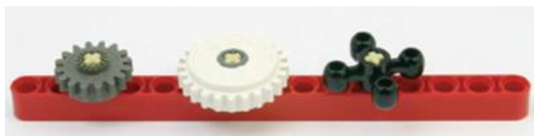
Εικόνα 22 Γρανάζια με ίδιο τύπο προεξοχών αλλά διαφορετικό μέγεθος
